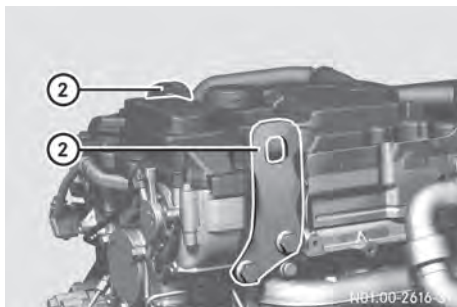
② 示例：飞轮侧吊点
